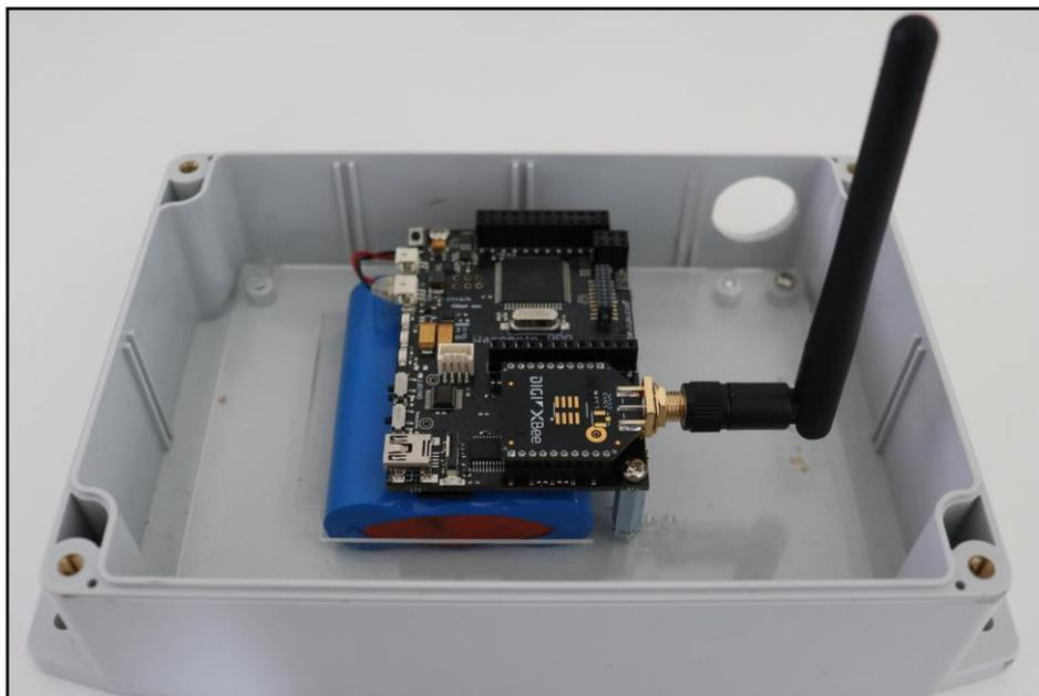
Figure 3.7. End device (Wasp mote) node.
