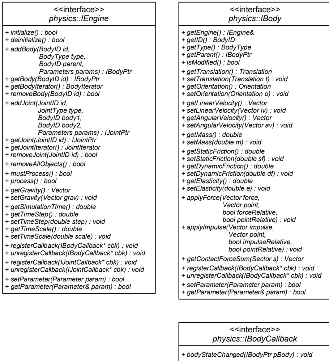
Abbildung 7.7: UML-Diagramm des Modulinterfaces der Physik-Engine (Teil 1)
