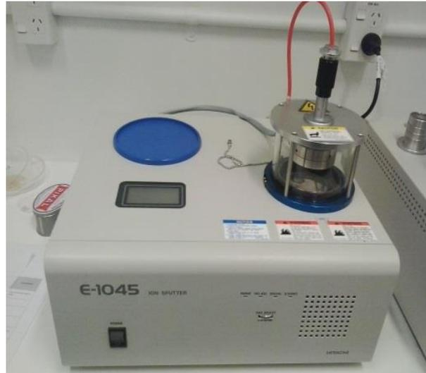
**Fig 2.2. HITACHI E-1045 magnetron sputter ion**
